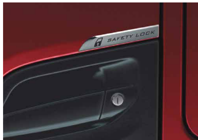
De centrale portiervergrendeling kan worden uitgebreid met een nachtbeveiligingsslot om de chauffeur van een zorgeloze nachtrust te verzekeren.
