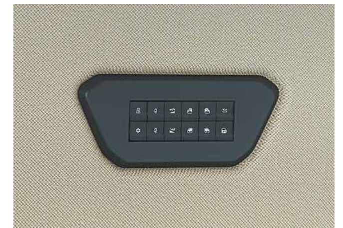
In de bedmodule zijn de bedieningsfuncties voor verlichting, verwarming, audio-installatie en portiervergrendeling samengebracht. Al deze functies kunnen ook worden bediend via de smartphone-app MYIVECO EasyWay.
